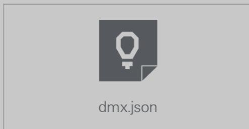
OP-Z 可以将音序器数据转换为 dmx 通道数据，并使用 usb dmx 接口发送出去。使用在 content 模式中找到的 dmx.json 文件来配置与您的 dmx fixture 设置相对应的传出通道数据，可配置的最大通道总数为 128。
