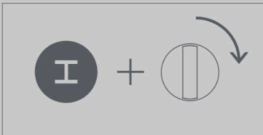
打开本机时按住轨道键，OP-Z 将以内容模式启动，所有轨道 LED 将为绿色。
